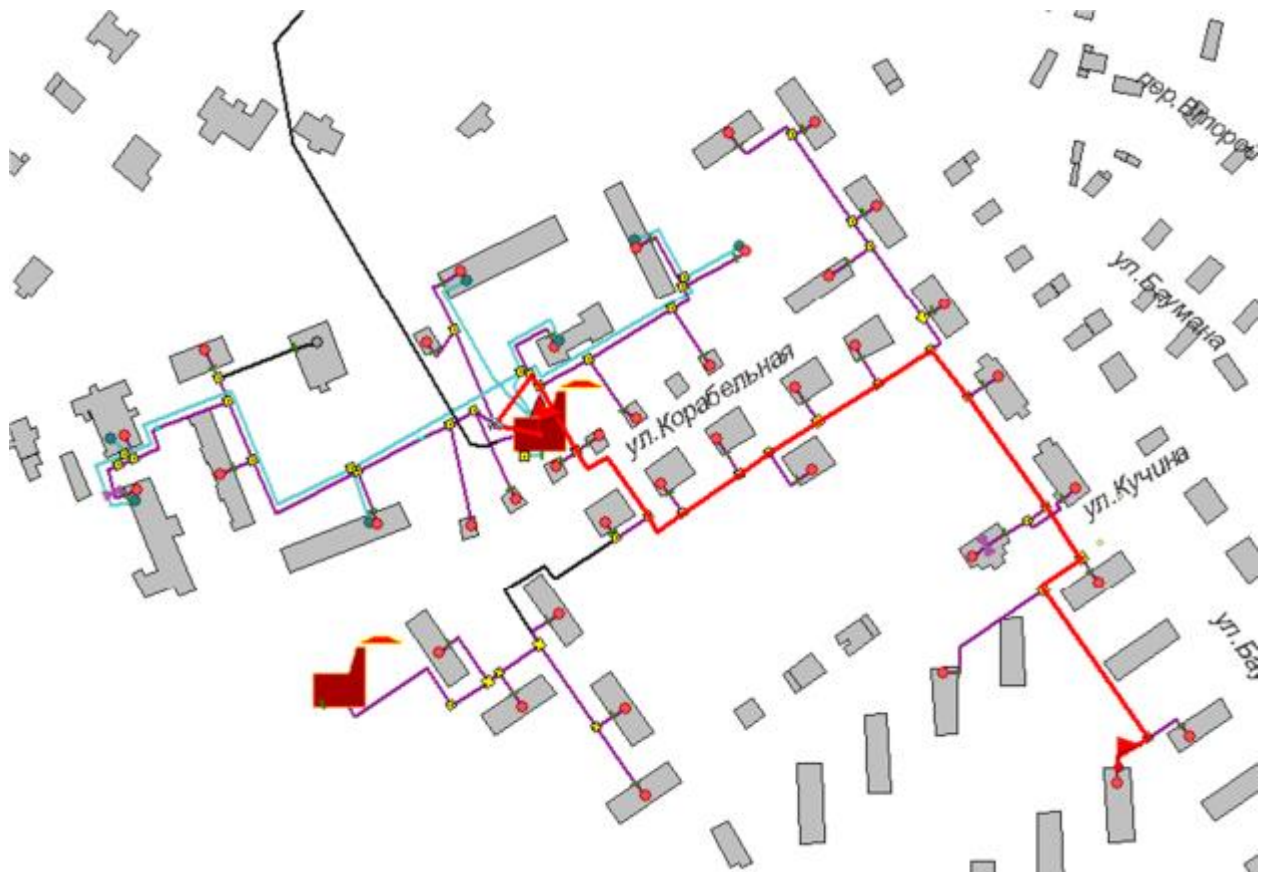
Рисунок 29.1 -Расчетный путь теплоносителя котельной до Баумана,12 к.4
