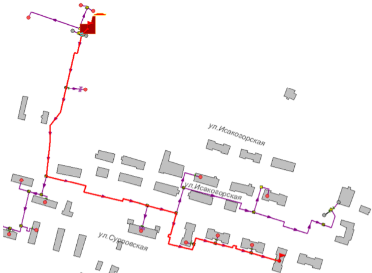
Рисунок 5.1 -Расчетный путь теплоносителя котельной до Сурповской, 20
