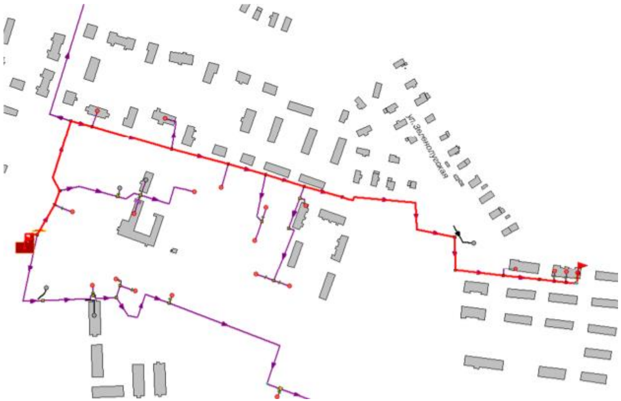
Рисунок 3.1 -Расчетный путь теплоносителя котельной до КЛДК 23, УУ1
