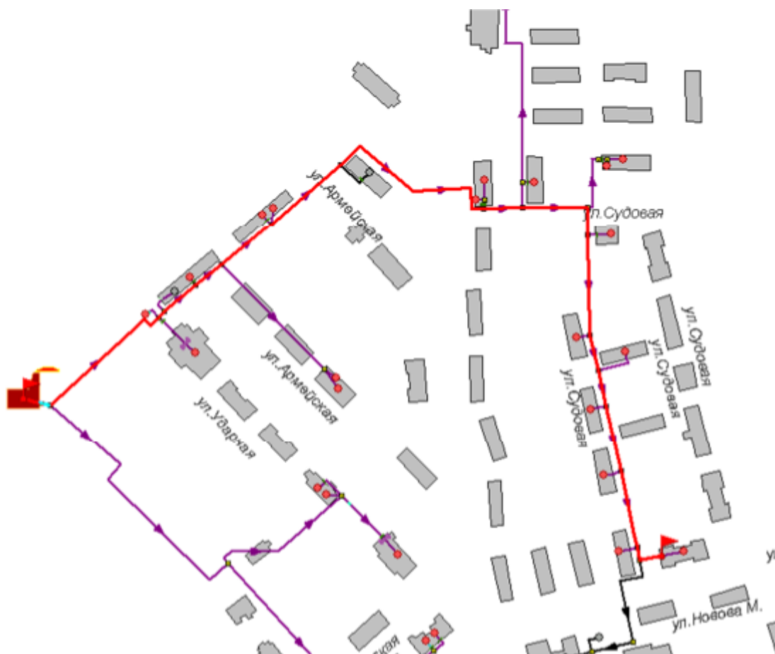
Рисунок 34.1 -Расчетный путь теплоносителя от котельной до Новова,17
