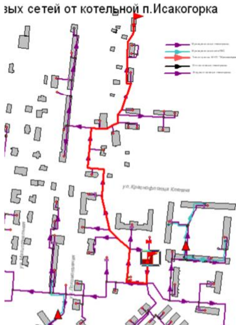
Рисунок 19.3 -Расчетный путь теплоносителя от котельной до Локомотивная,1
