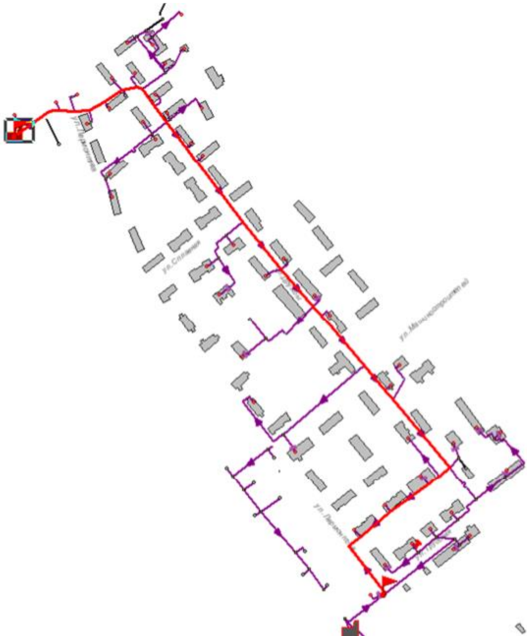
Рисунок 13.1 -Расчетный путь теплоносителя котельной до Лермонтова 23, стр.20
