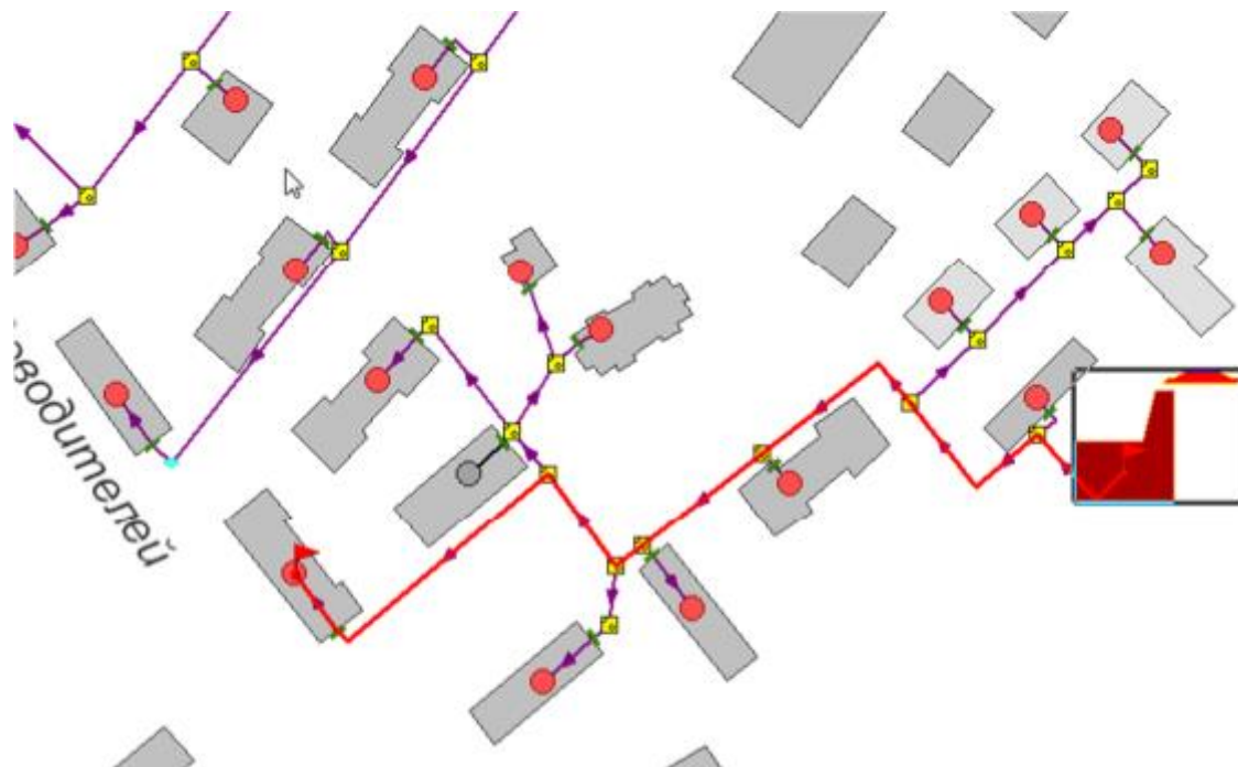
Рисунок 17.1 -Расчетный путь теплоносителя котельной до Речников,29
