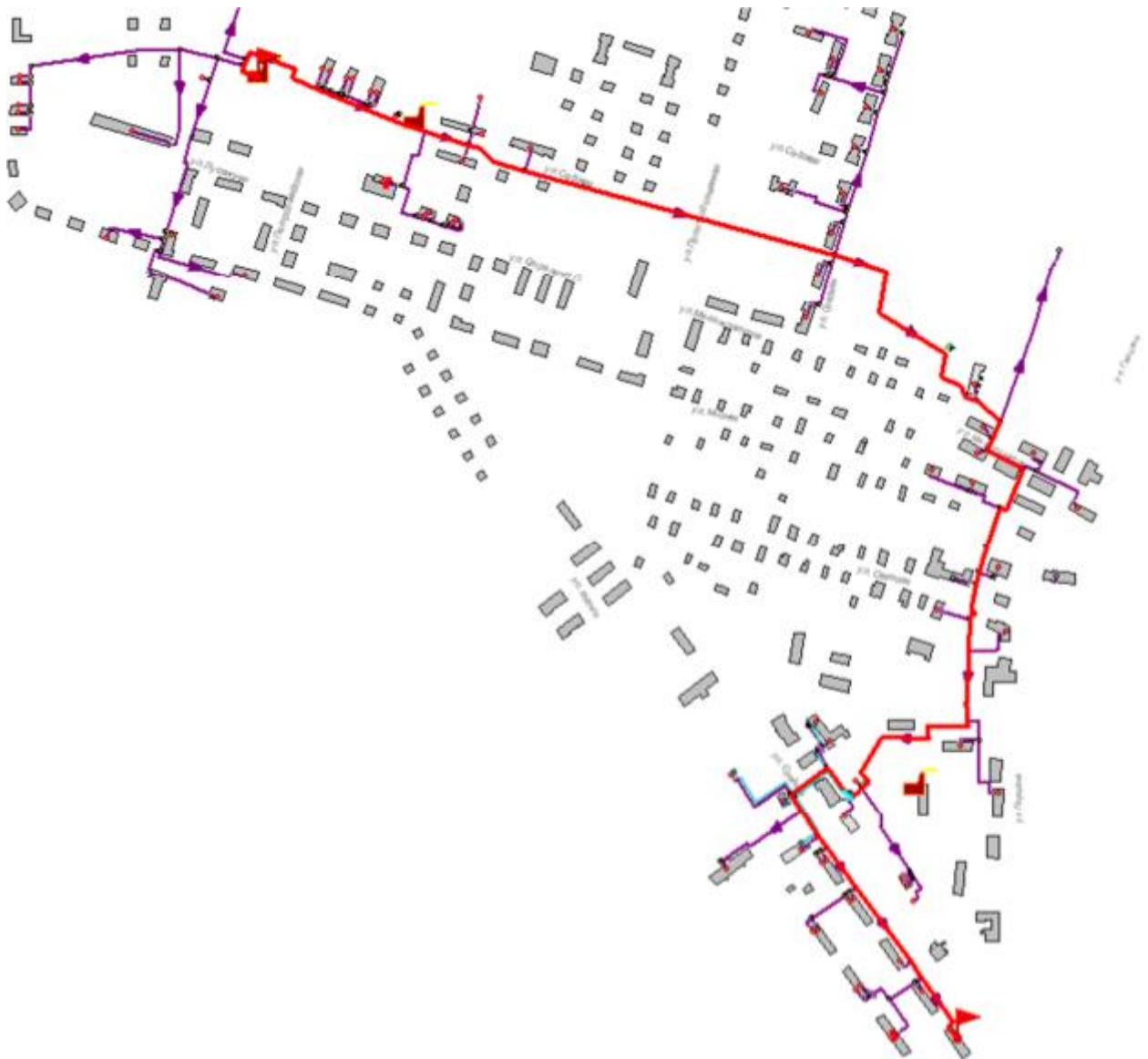
Рисунок 26.1 -Расчетный путь теплоносителя котельной до Юнг МФ,17
