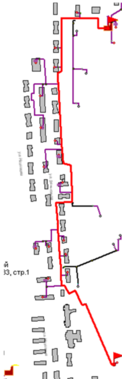
Рисунок 11.1 -Расчетный путь теплоносителя котельной до Пластмассового завода
