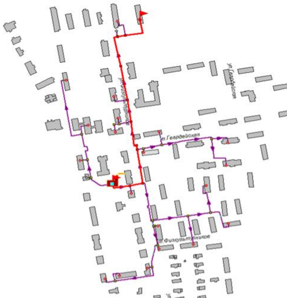
Рисунок 28.1 -Расчетный путь теплоносителя от котельной до Петрова,9
