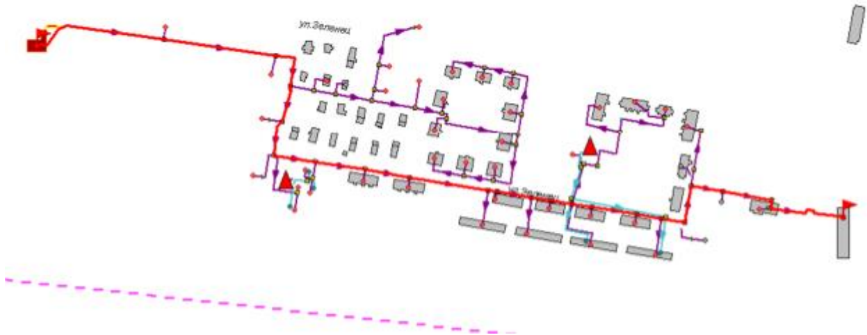
Рисунок 4.1 -Расчетный путь теплоносителя котельной до Зеленец, 1 к.1
