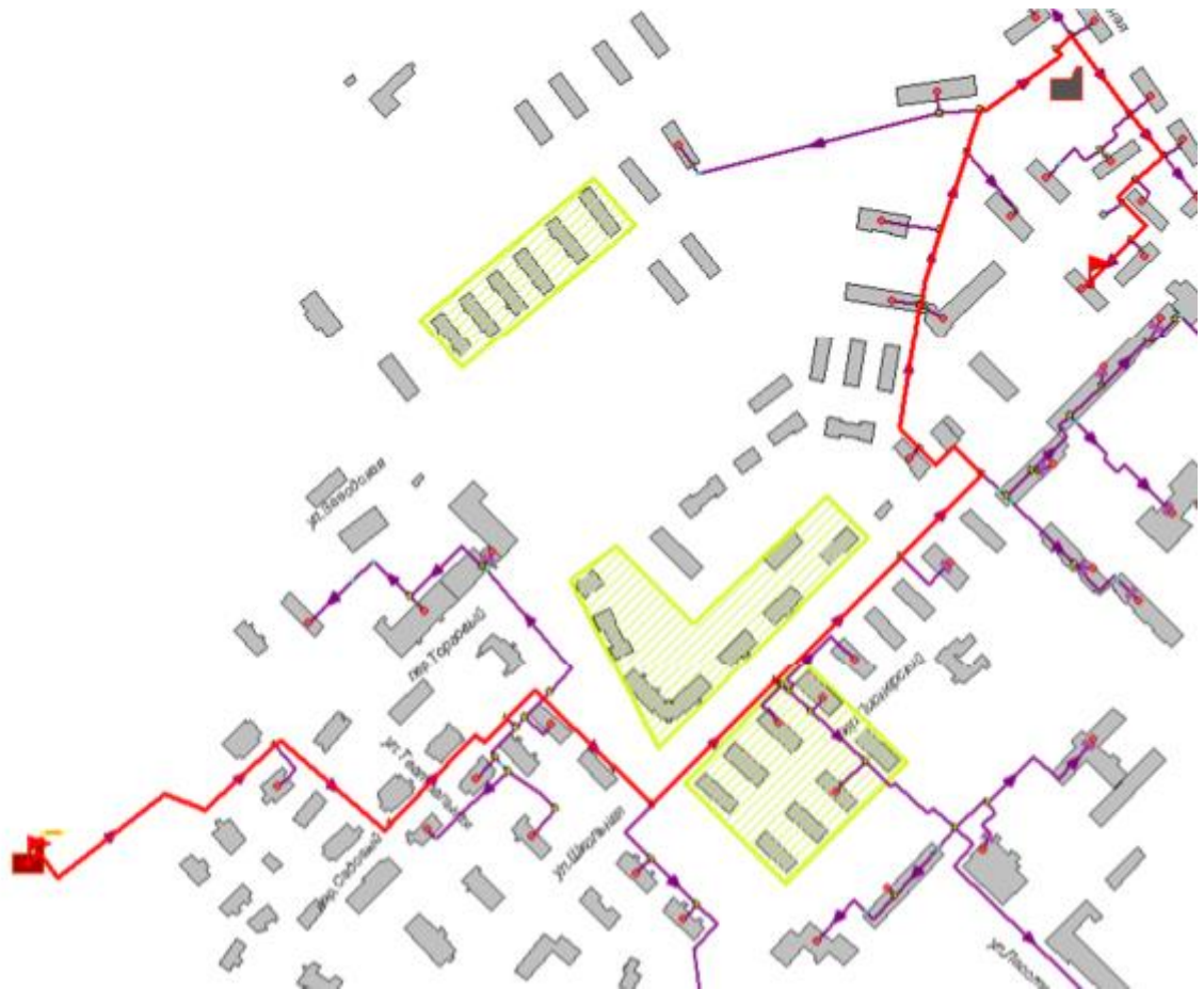
Рисунок 33.1 -Расчетный путь теплоносителя котельной до Школьная,162
